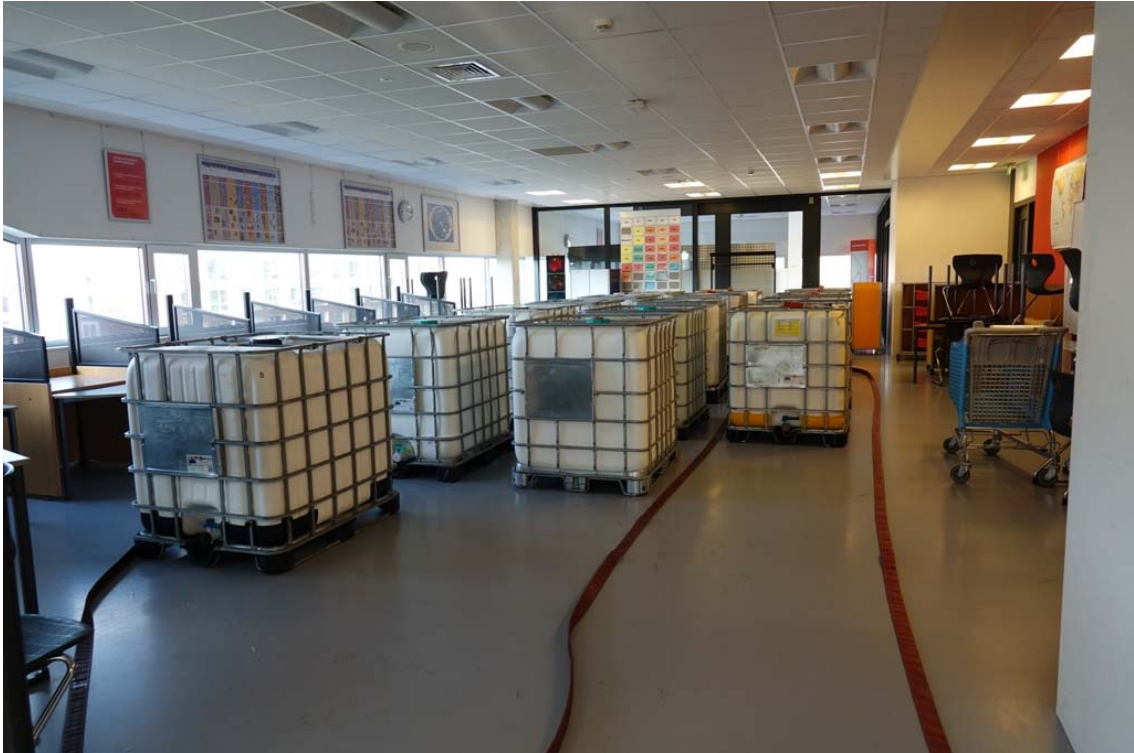
figuur 3 Voorbeeld van uitvoering van proefbelasting met water.
